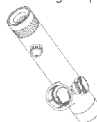
3. Helyezze be az elemtartót, ügyelve annak irányára és pozíciójára
