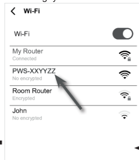
(d) Válassza ki a konzol Wi-Fi-hálózatának nevét (a név mindig PWS- előtaggal kezdődik), hogy okostelefonját a konzolhoz csatlakoztassa. Ezután térjen vissza a WSLink alkalmazásba.
